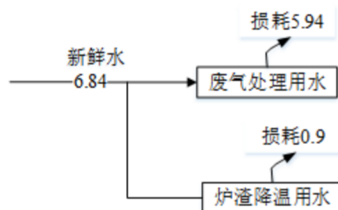
图 2-1 改建项目水平衡图 单位 (m³/a)
